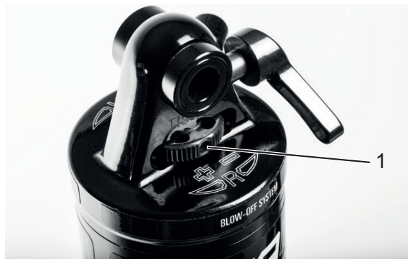
Abbildung 61: Suntour-Zugstufeneinsteller Rad (1) am Hinterbau-Dämpfer
