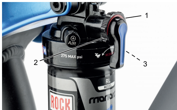
Abbildung 79: Härte des Zugstufen-Dämpfers am Einstellrad (1) des Hinterbau-Dämpfer einstellen
