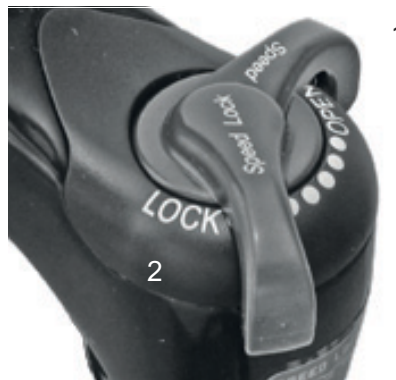
Abbildung 73: Suntour-Druckstufen-Einsteller mit den Positionen OPEN (1) und LOCK (2)
