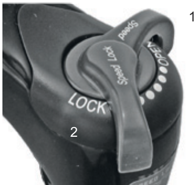
Abbildung 77: Suntour-Druckstufen-Einsteller mit den Positionen OPEN (1) und LOCK (2)
