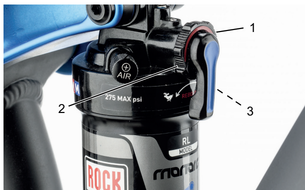
Abbildung 83: Härte des Zugstufen-Dämpfers am Einstellrad (1) des Hinterbau-Dämpfer einstellen
