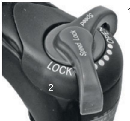
**Abbildung 67:** Suntour-Druckstufeneinsteller mit den Positionen OPEN (1) und LOCK (2)
