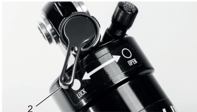
**Abbildung 67:****Suntour-Druckstufeneinsteller geschlossen (2)**
