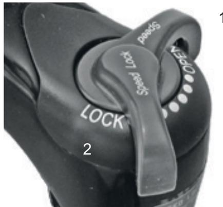
**Abbildung 64:** Suntour-Druckstufeneinsteller mit den Positionen OPEN (1) und LOCK (2)
