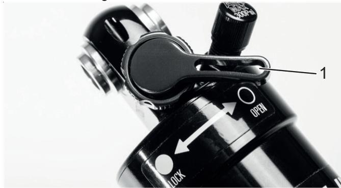
**Abbildung 66:****Suntour-Druckstufeneinsteller geöffnet (1)**
