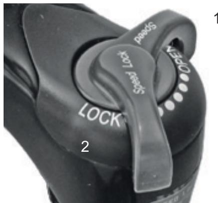
**Abbildung 65:** Suntour-Druckstufeneinsteller mit den Positionen OPEN (1) und LOCK (2)
