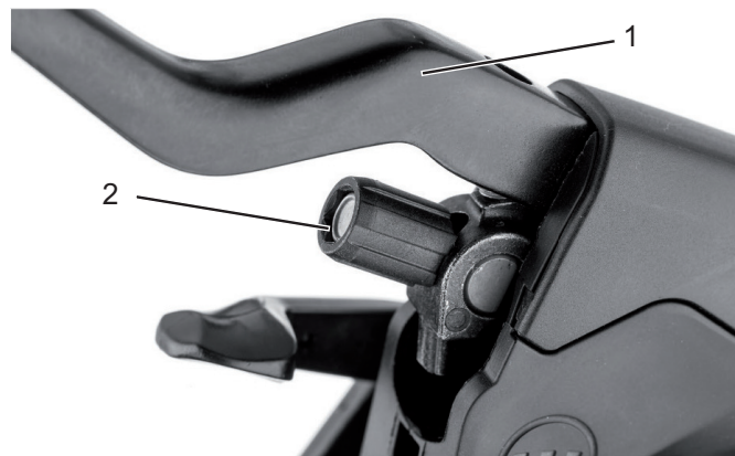
Abbildung 65: Bremshebel (1) der hydraulisch betätigten Felgenbremse mit Einstellschraube (2)
