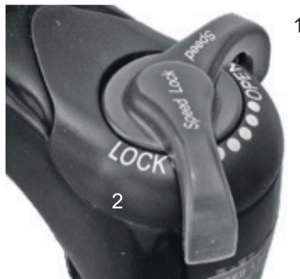
Abbildung 57: Suntour-Druckstufeneinsteller mit den Positionen OPEN (1) und LOCK (2)
