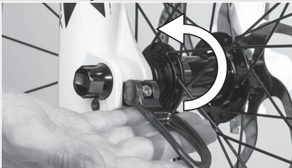
Abbildung 30: Hebel sichern
