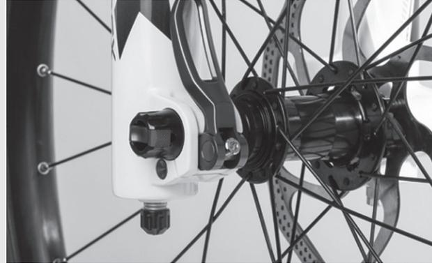
Abbildung 31: Perfekte Lage des Spannhebels
