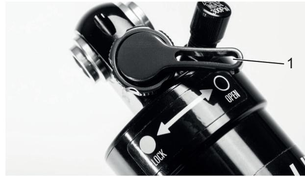
Abbildung 67: Suntour-Druckstufeneinsteller geöffnet (1)
