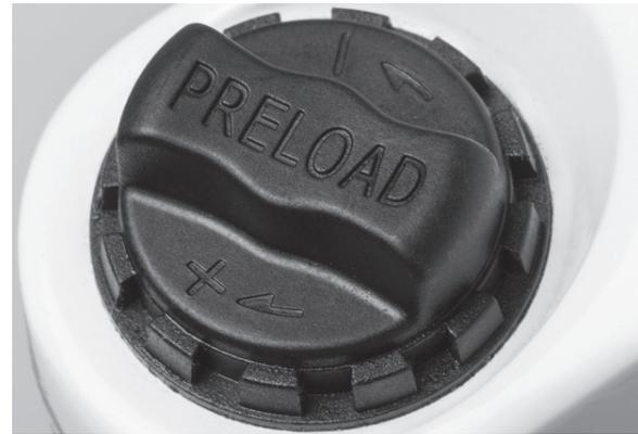
Abbildung 53: Einstellrad des Negativfederwegs auf der Krone der Federgabel
