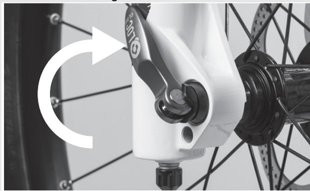
Abbildung 36: Schnellspanner schließen
