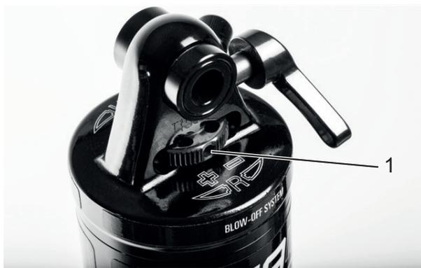
Abbildung 57: Suntour-Zugstufeneinsteller Rad (1) am Hinterbau-Dämpfer
