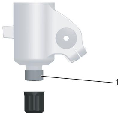
Abbildung 56: FOX-Zugstufen-Einsteller (1) am Ausfallende der Gabel
