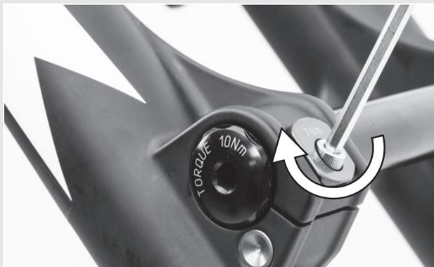
Abbildung 26: Sicherheitsklemme anziehen
