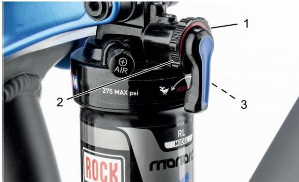
Abbildung 69: Härte des Zugstufen-Dämpfers am Einstellrad (1) des Hinterbau-Dämpfer einstellen
