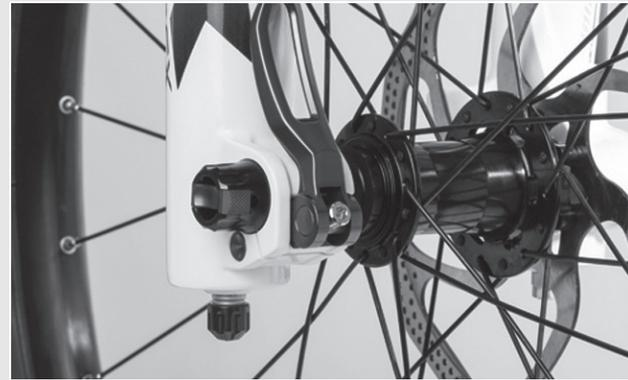
Abbildung 74: Spannkraft des Schnellspanners einstellen
