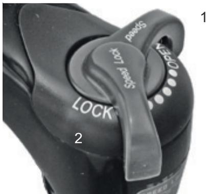
Abbildung 66: Suntour-Druckstufeneinsteller mit den Positionen OPEN (1) und LOCK (2)
