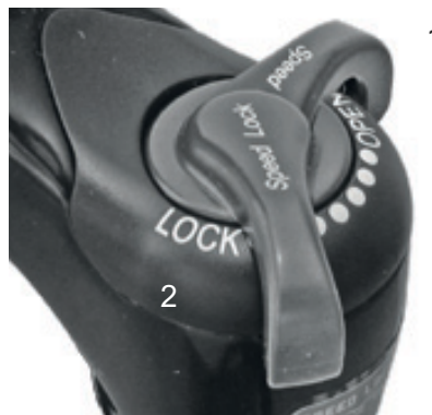
Abbildung 67: Suntour-Druckstufeneinsteller mit den Positionen OPEN (1) und LOCK (2)
