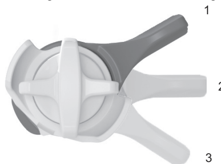
Abbildung 65: FOX-Druckstufeneinsteller am Hinterbau-Dämpfer mit den Positionen OFFEN (1), MITTEL (2) und HART (3)
