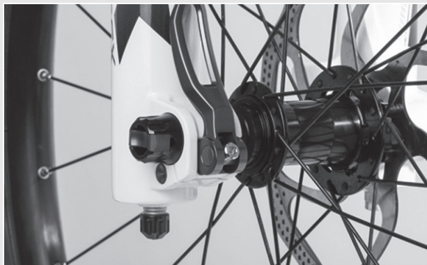
Abbildung 87: Spannkraft des Schnellspanners einstellen
