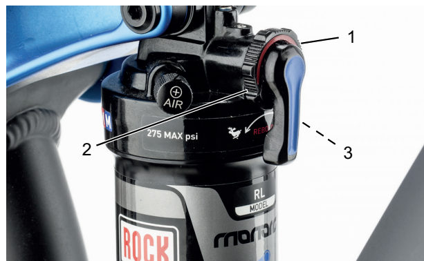
Abbildung 70: Härte des Zugstufen-Dämpfers am Einstellrad (1) des Hinterbau-Dämpfer einstellen
