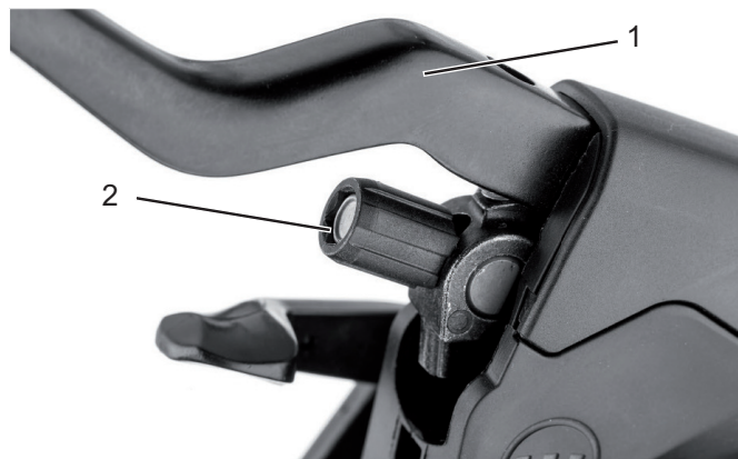
Abbildung 70: Bremshebel (1) der hydraulisch betätigten Felgenbremse mit Einstellschraube (2)
