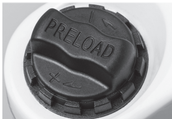
Abbildung 59: Einstellrad des Negativfederwegs auf der Krone der Federgabel
