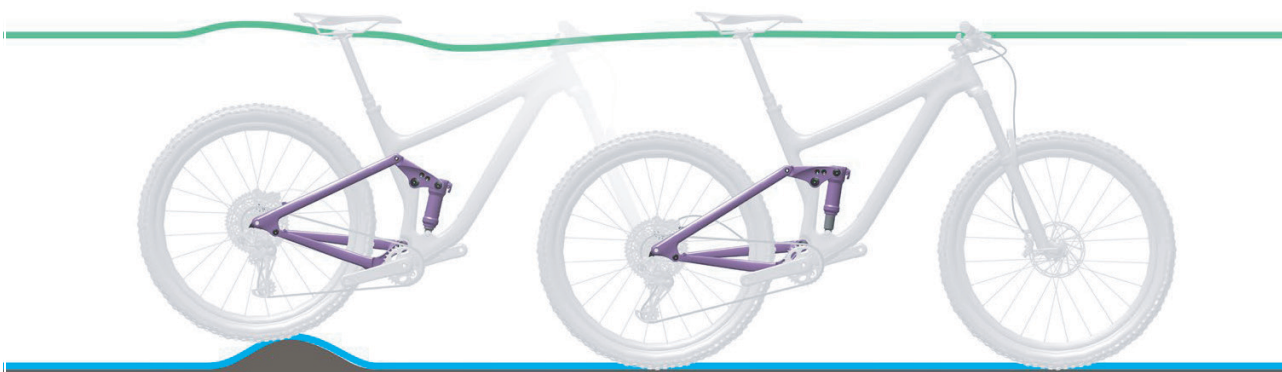
Abbildung 98: Optimales Fahrverhalten des Hinterbau-Dämpfers bei Unebenheiten
