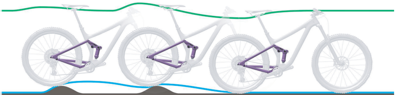
Abbildung 144: Zu langsames Ausfedern des Hinterbau-Dämpfers
