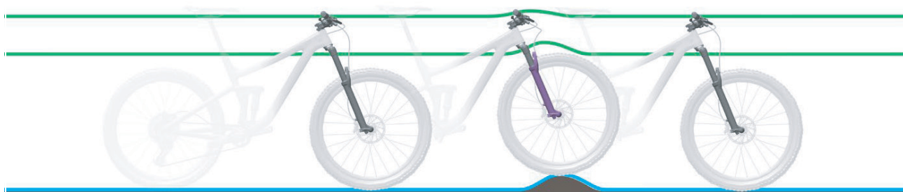
Abbildung 7: Optimales Fahrverhalten der Gabel bei Unebenheiten
