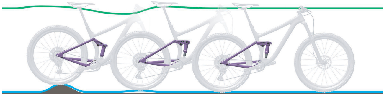
Abbildung 142: Zu schnelles Ausfedern des Hinterbau-Dämpfers
