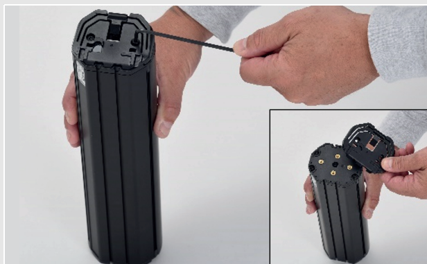
Abbildung 44: Demontage oberes Interface
