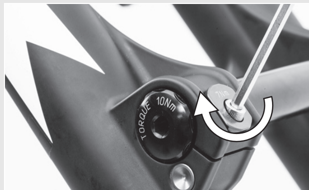
Abbildung 53: Sicherheitsklemme anziehen
