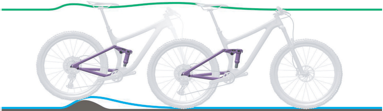
Abbildung 148: Zu harte Dämpfung des Hinterbau-Dämpfers bei Unebenheiten
