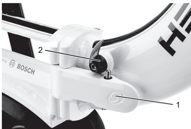
Abbildung 96: Geschlossener (1) und geöffneter (2) Rahmen-Sicherungshebel
