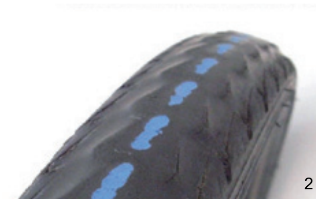
Abbildung 137: Reifen ohne Profil, der gewechselt werden kann (1), und Reifen mit durchscheinendem Pannenschutz (2), der gewechselt werden muss
