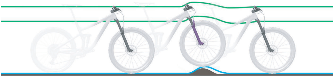
Abbildung 217: Zu harte Dämpfung der Federgabel bei Unebenheiten
