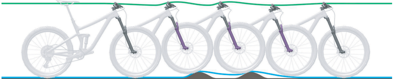
Abbildung 213: Zu langsames Ausfedern der Federgabel
