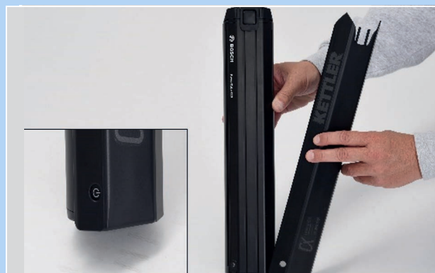
Abbildung 56: Akku-Cover auf Akku schieben
