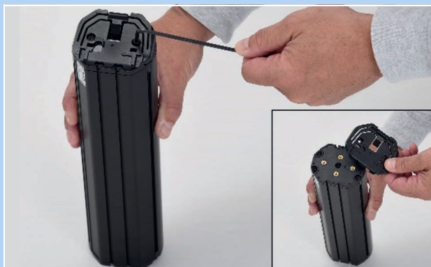
Abbildung 72: Demontage oberes Interface
