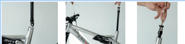
Abbildung 162: Kartusche Ventildeckel befestigen
