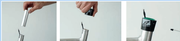
Abbildung 191: Gleitbuchse und Außenhülse einbauen
