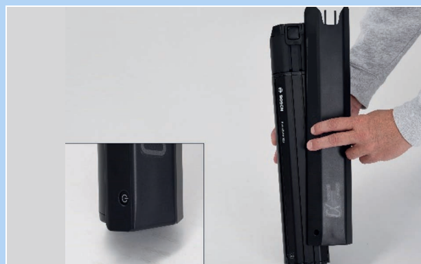
Abbildung 75: Akku-Cover auf Akku schieben
