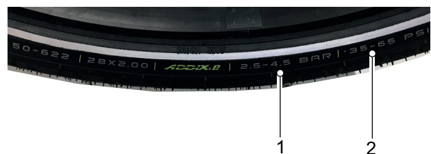
Abbildung 121: Fülldruck in bar (1) und psi (2)
