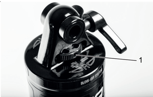
Abbildung 213: Suntour-Zugstufeneinsteller Rad (1) am Hinterbau-Dämpfer
