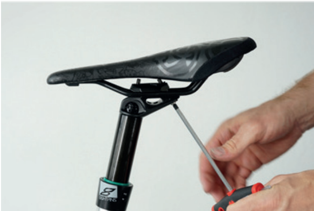
Abbildung 115: Hintere Schraube lockern
