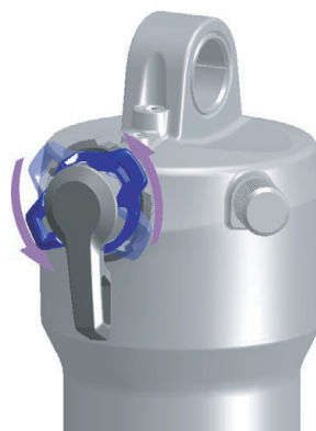
Abbildung 72: Druckstufeneinsteller weicher einstellen
