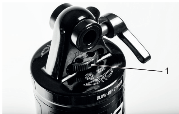
Abbildung 64: Suntour-Zugstufeneinsteller Rad (1) am Hinterbau-Dämpfer
