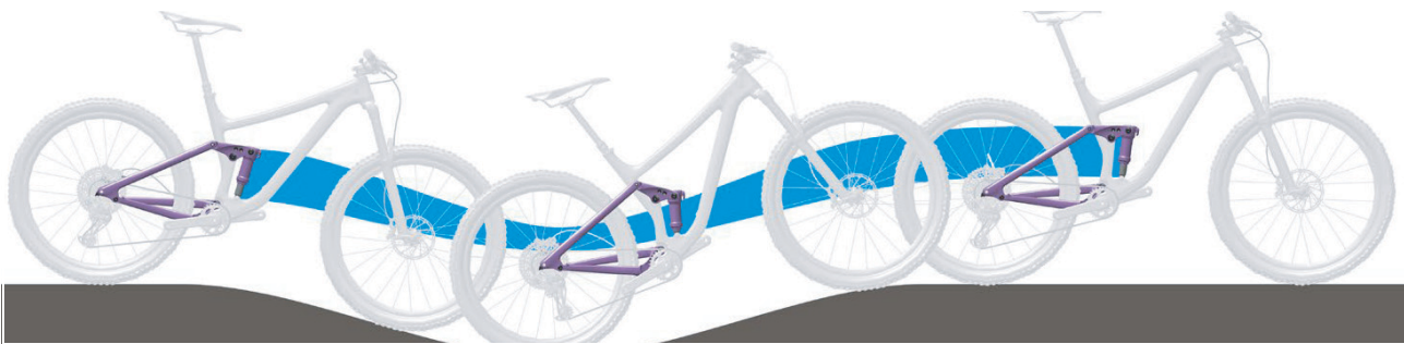
Abbildung 101: Zu weiche Federung des Hintebau-Dämpfers am Berg
