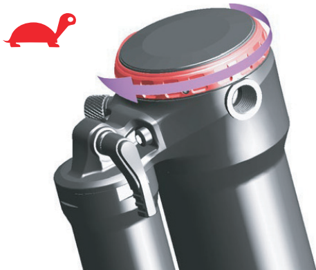
Abbildung 98: Zugstufendämpfer in Richtung Schildkröte drehen
