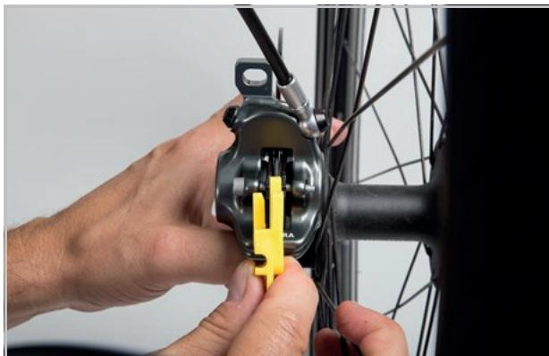
Abbildung 145: Bremsbelag im eingebauten Zustand mithilfe der Transportsicherung prüfen
