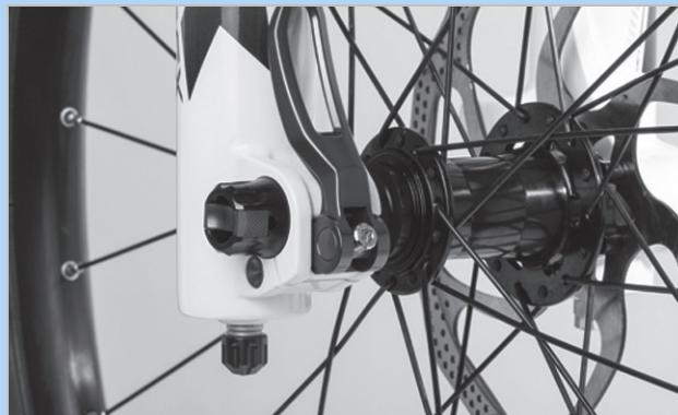
Abbildung 173: Spannkraft des Schnellspanners einstellen
