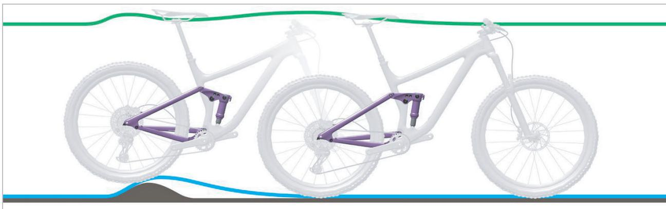
Abbildung 189: Zu harte Dämpfung des Hinterbau-Dämpfers bei Unebenheiten
