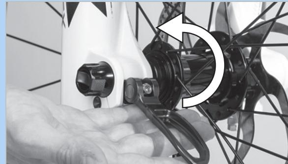
Abbildung 70: Schnellspannhebel in Pfeilrichtung drücken
