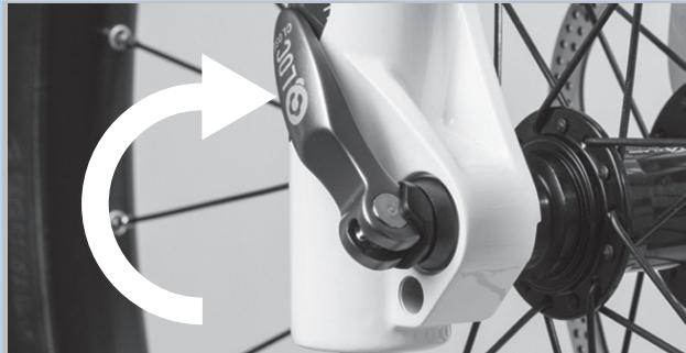
Abbildung 76: Schnellspanner schließen
