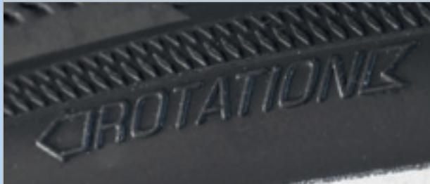
Abbildung 60: Laufrichtungspfeil
