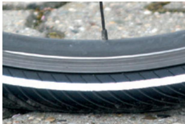
Abbildung 103: Korrekter Fülldruck. Der Reifen ist unter der Last des Körpergewichts kaum verformt
