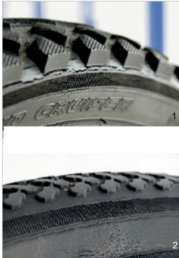
Abbildung 144: Beispiele für Ermüdungsrisse (1) und Alterungsrisse (2)
