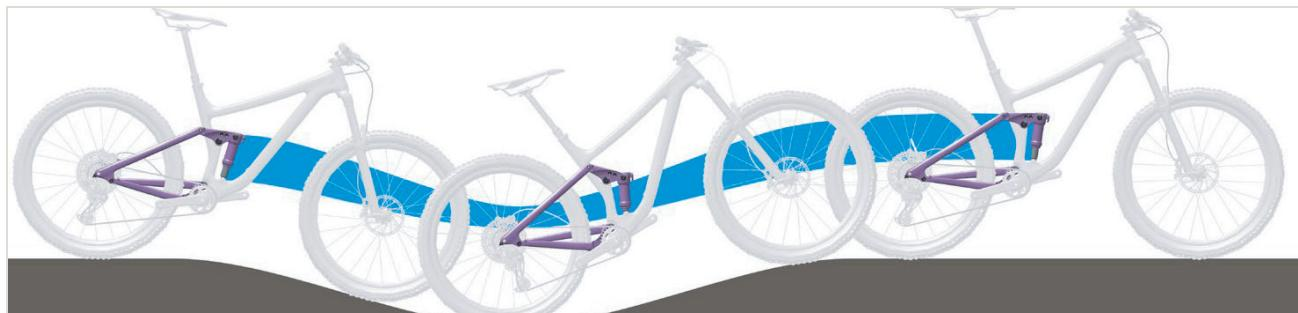
Abbildung 187: Zu weiche Federung des Hinterbau-Dämpfers am Berg
