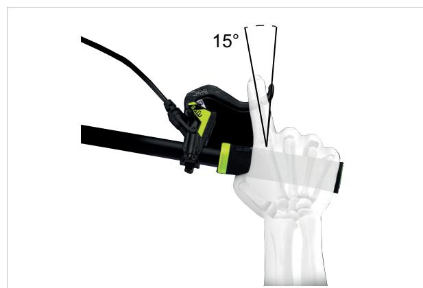
Abbildung 105: Position der Handbremse
