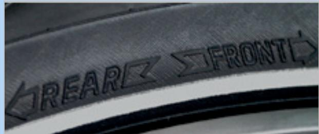
Abbildung 61: Laufrichtungspfeil auf MTB-Reifen
