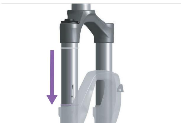
Abbildung 113: O-Ring der Federgabel verschieben
