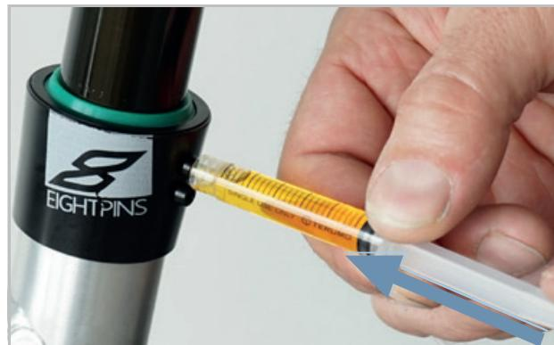
Abbildung 141: EIGHTPINNS Sattelstütze schmieren
