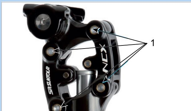
Abbildung 175: Schmierpunkte SR SUNTOUR Feder-Sattelstütze
