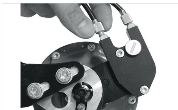
Abbildung 170: ROHLOFF-Naben Versionen mit externer Schaltansteuerung haben die Zugeinsteller an der Seilbox, die sich auf der linken Seite befindet
