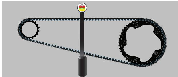
Abbildung 164: Aufgehängerter Messstab
