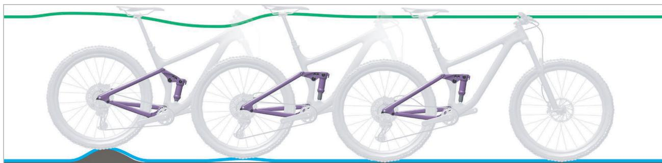
Abbildung 183: Zu schnelles Ausfedern des Hinterbau-Dämpfers
