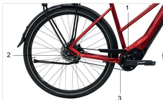
Abbildung 41: Schema Riemenantrieb
