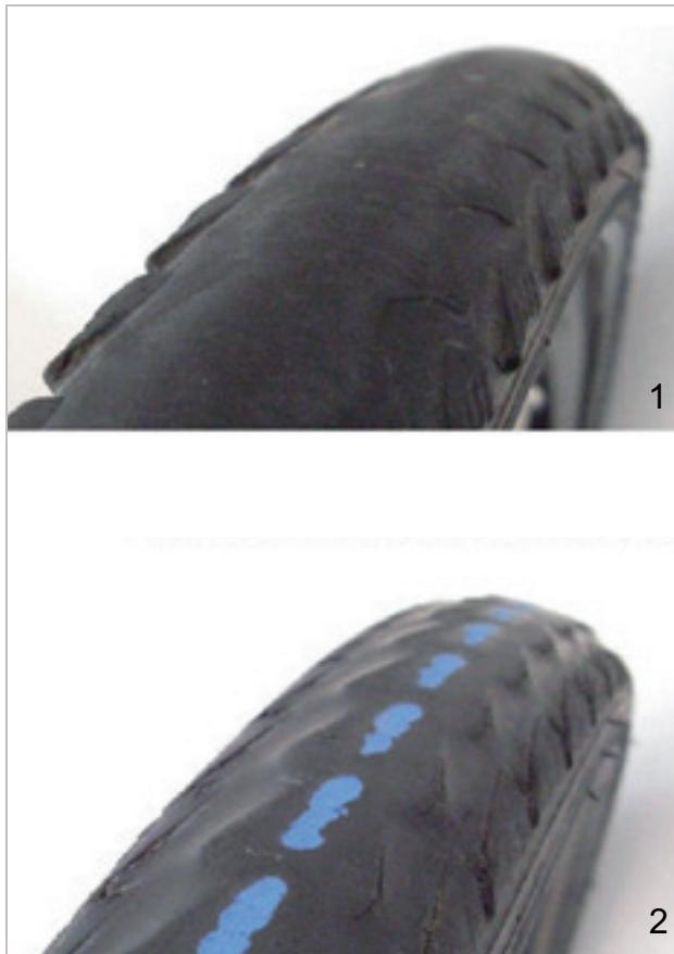
Abbildung 143: Reifen ohne Profil, der gewechselt werden kann (1) und Reifen mit durchscheinendem Pannenschutz (2), der gewechselt werden muss
