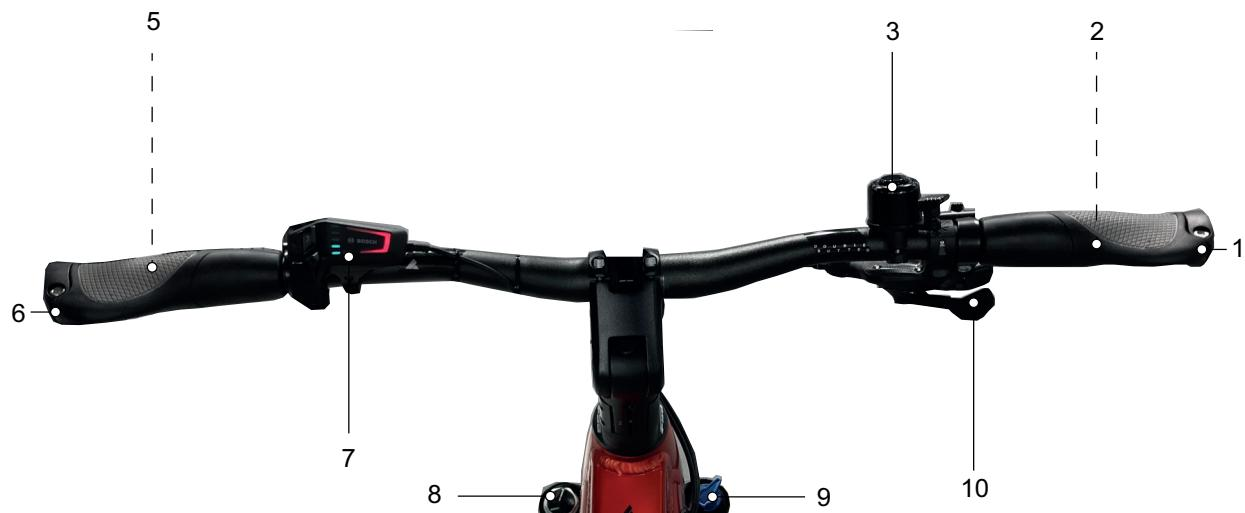
Abbildung 48: Detailansicht Lenker mit BOSCH Kiox 300, Beispiel
