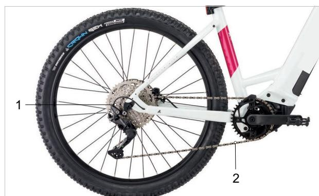
Abbildung 40: Schema Kettenantrieb mit Kettenschaltung
